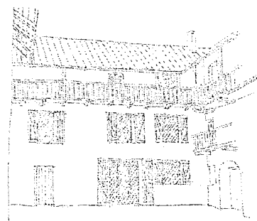
Mauvais exemple d'agrandissement d'ouvertures, modifiant les proportions entre les pleins et les vides, ce qui altère l'identité du bâtiment.
